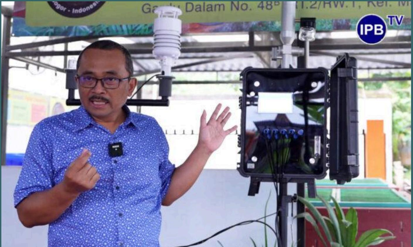
**T**im peneliti IPB University mengembangkan alat pemantau kualitas udara bernama Air Quality IPB Monitoring System (AQIMOS), sebuah inovasi untuk mempercepat dan mempermudah pemantauan Indeks Standar Pencemar Udara (ISPU) secara real-time. Alat ini hadir dalam bentuk statis maupun portable, dan diklaim jauh lebih efisien serta ekonomis dibandingkan alat konvensional yang selama ini digunakan.
